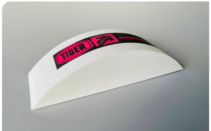
Inkjet-Dekoration auf einem 3D-gedruckten Bauteil
