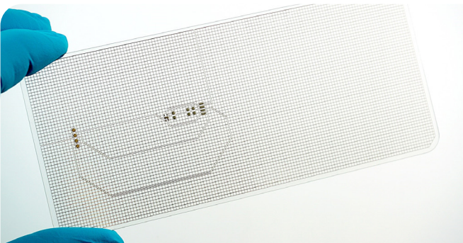
Semitransparente Leiterbahnen für intelligente Fenster
